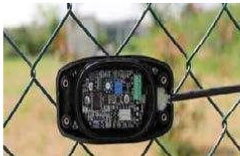
Sistema intelligente caratterizzato da sensori antiscavalamento, taglio e antisfondamento per la protezione perimetrale per box, portoni, cancelli, reti, inferriate, vetrate, griglie, grate.
