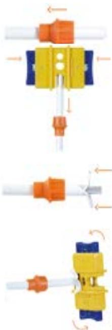
5 Inserire il cavo nel connettore F, ripiegare sulla filettatura la guaina con la calza e far scivolare il Cap sopra di esse.
